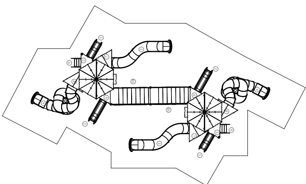
Utilização do equipamento sujeito a condições vigiadas; Zona de segurança: Área mínima requerida pela norma EN 1176-1.6
