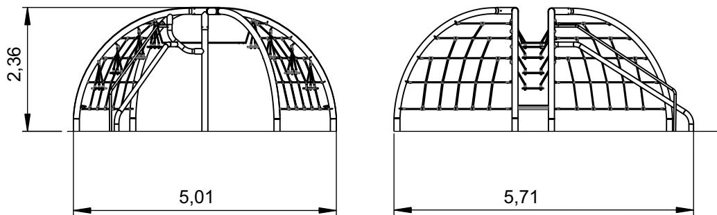
Utilização do equipamento sujeito a condições vigiadas; Zona de segurança: Área mínima requerida pela norma EN 1176-1
