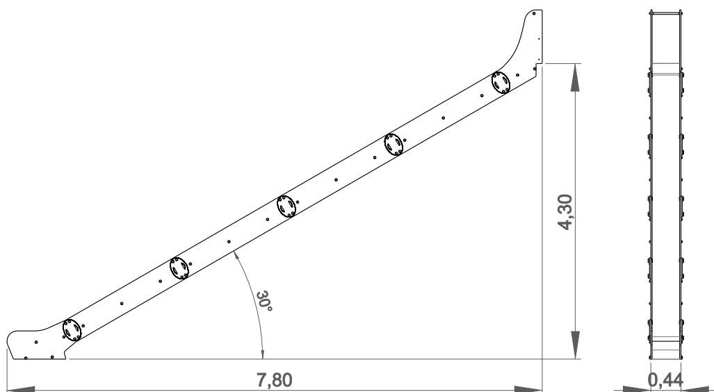
Utilização do equipamento sujeito a condições vigiadas; Zona de segurança: Área mínima requerida pela norma EN 1176-1,3
